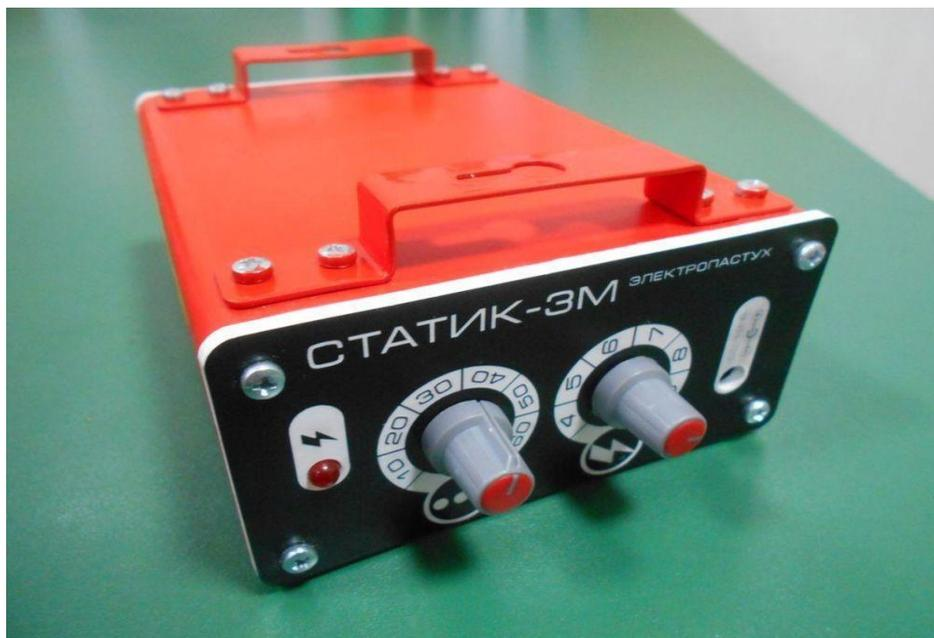
Рисунок 2 - Генератор импульсов
